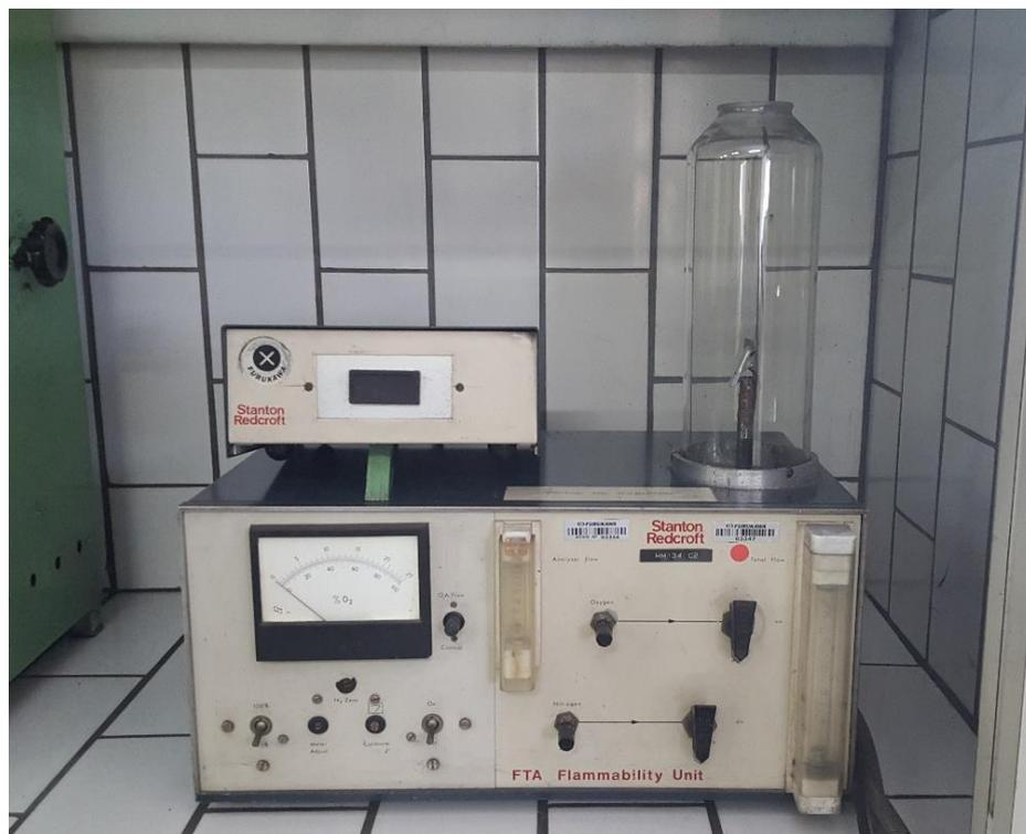
Figura 13 – Unidade de flamabilidade Station Red Croft – modelo MM34 C2
