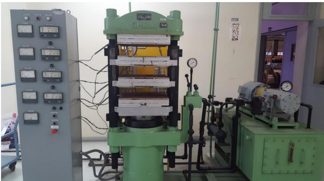
**Figura 12 - Prensa marca Shoji, modelo 3 stages, utilizada na preparação dos corpos de prova**
