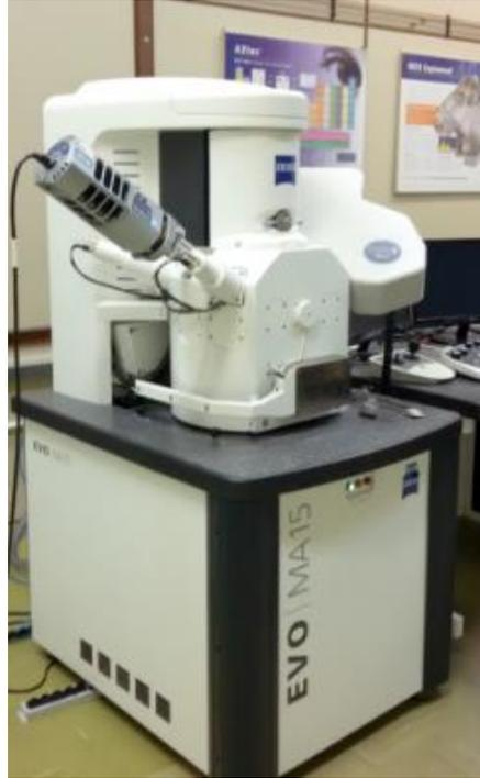
**Figura 18 – Microscópio eletrônico de varredura**
