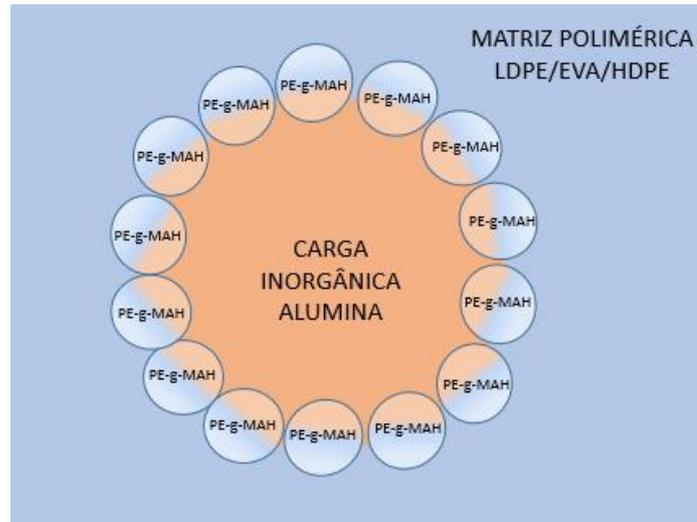
**Figura 9 - Desenho esquemático de carga inorgânica compatibilizada com PE-g-MAH**
