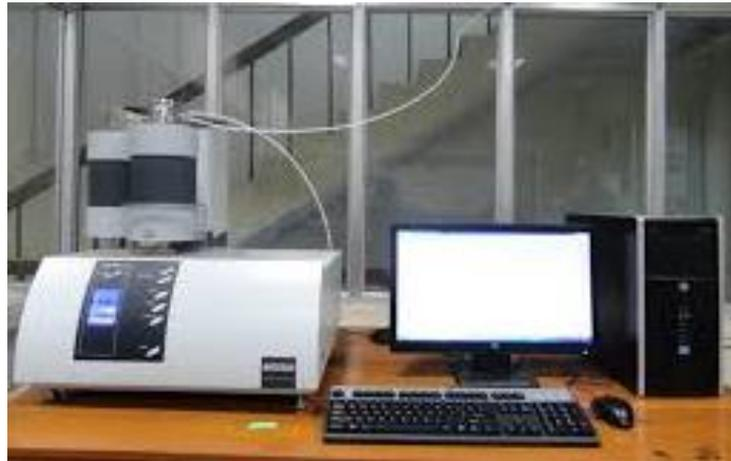
**Figura 17 - Equipamento de calorimetria diferencial exploratoria**
