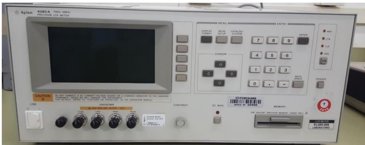
Figura 14 – Capacímetro Indutímetro Agilent, modelo 4285A
