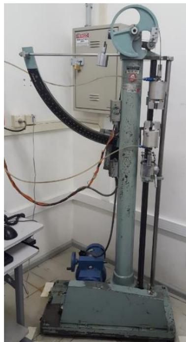
Figura 16 – Máquina de ensaios universal Schopper, modelo C1T5T
