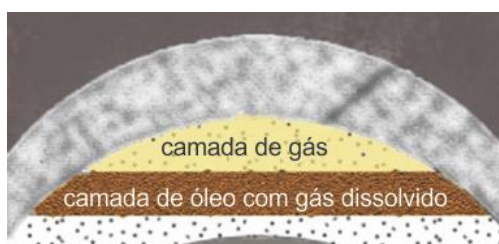
Figura 5.1. Reservatório de petróleo com gás no topo e óleo em baixo.
