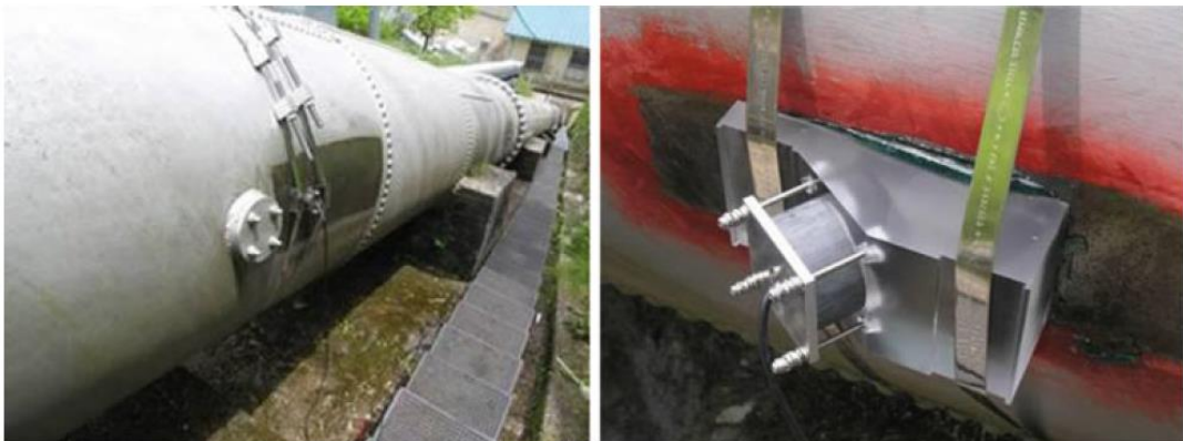
Figura 2.7. Experimento realizado por Tezuka (2008) para medição do perfil de velocidade em tubos largos em uma usina hidrelétrica.
