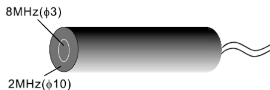
Figura 5.17. Transdutor de duas frequências proposto por Murakawa, Kikura e Aritomi (2005; 2004).
