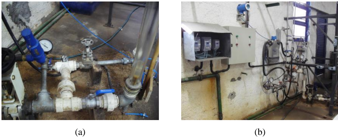
Figura 6.3. (a) Ponto de injeção de gás no escoamento e (b) Sistema de controle e medição das vazões de líquido.
