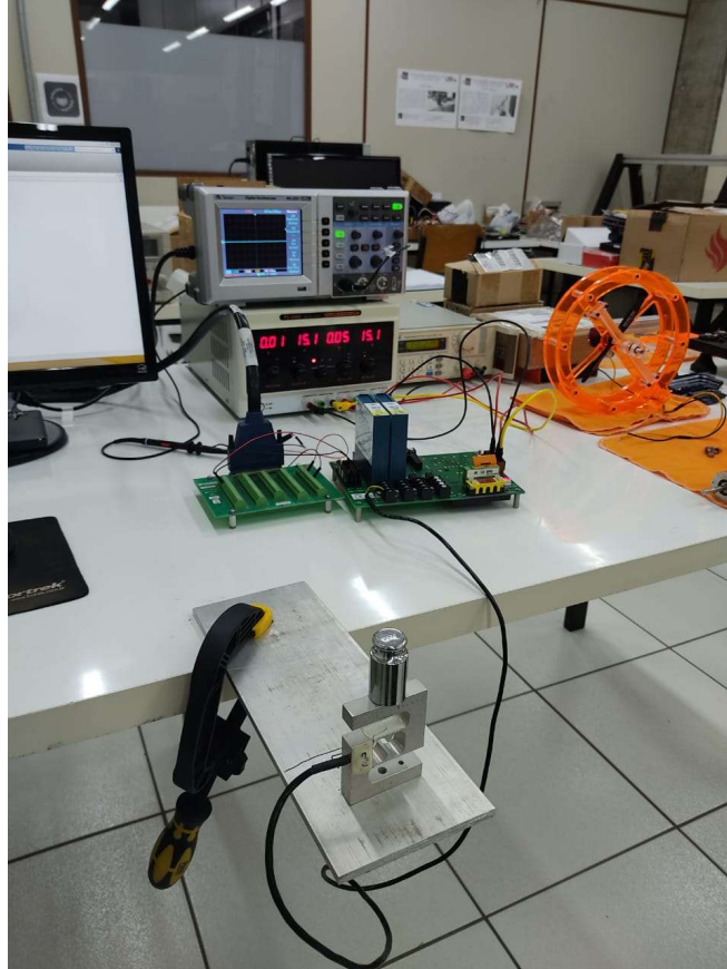
Figura 5.2 – Processo de calibração da célula de carga em laboratório Fonte: Autoria própria
