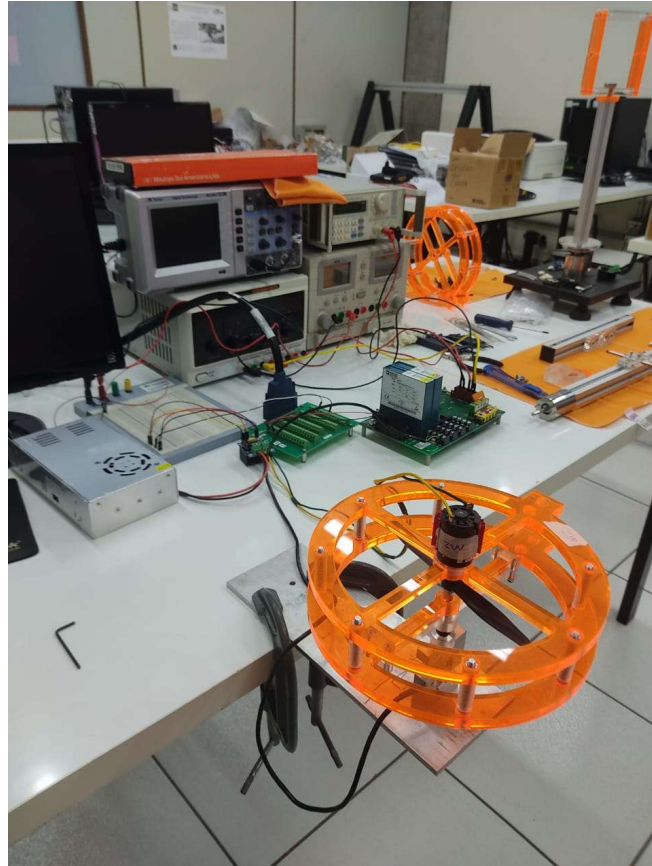
Figura 5.10 – Processo de identificação dos motores em laboratório Fonte: Autoria própria
