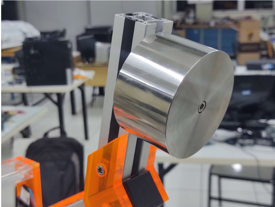
Figura 7.24 – Geometria do contrapeso complicando posicionamento Fonte: Autoria própria
