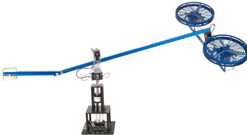
Figura 1.3 – Helicóptero 3 GDL da Quanser Fonte: Quanser (2017)
