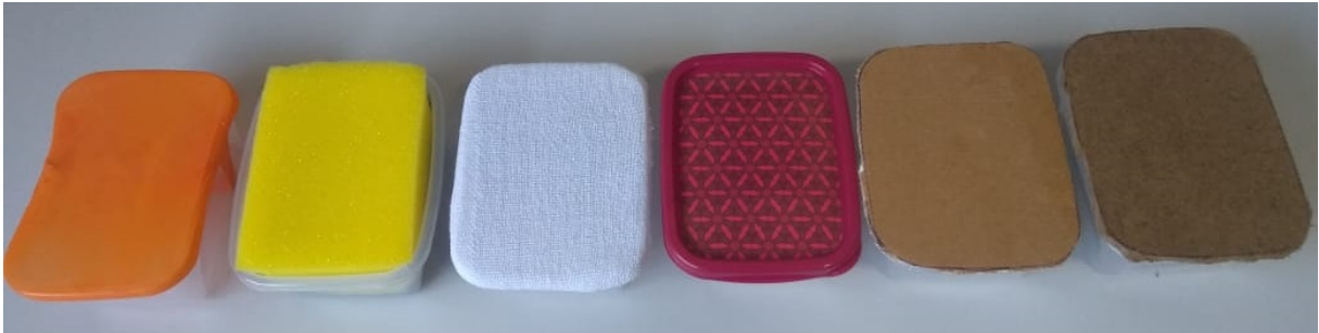
Figura 1: Materiais reais usados no experimento (da esquerda para a direita): borracha, esponja, tecido, plástico, papelão e madeira.
