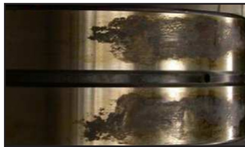
Figura 8 – Rolamento apresentando corrosão no anel externo.
