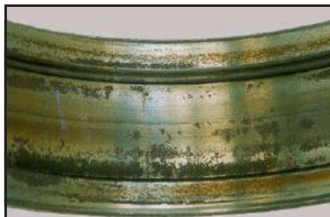
Figura 7 – Rolamento apresentando corrosão na pista externa causada por umidade.
