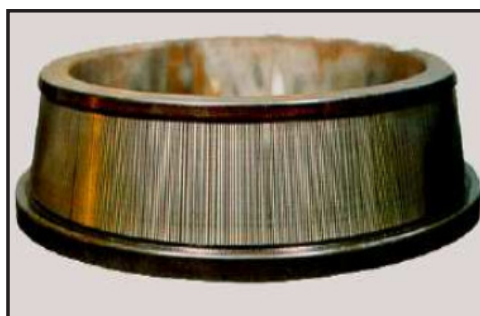
Figura 11 – Crateras formadas por fuga de corrente resultando em ondulações na pista do rolamento.
