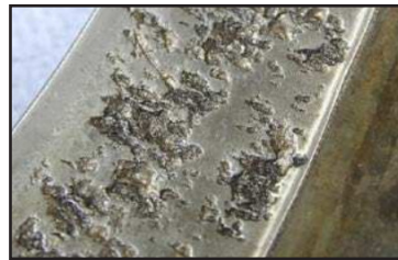
Figura 4 – Rolamento apresentando descascamento avançado no anel externo causado pela fadiga superficial.
