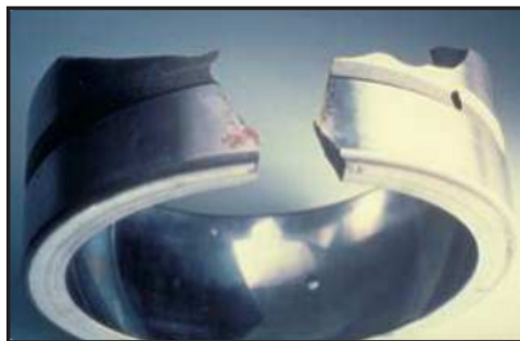
Figura 15 – Rolamento apresentando fratura forçada originada por corrosão de contato.
