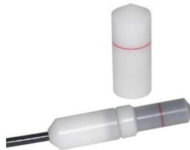
Figura 12 - Câmara de ionização tipo lápis, modelo 10x6-0.6CT, da marca Radcal Corporation
