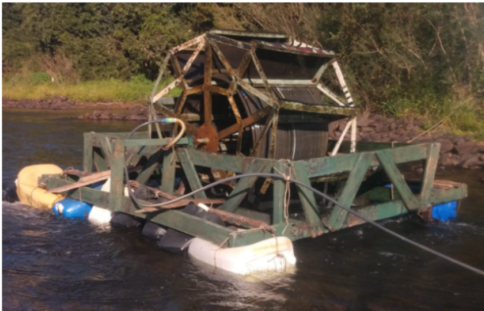
Figura 38 – Terceiro protótipo da bomba em funcionamento
