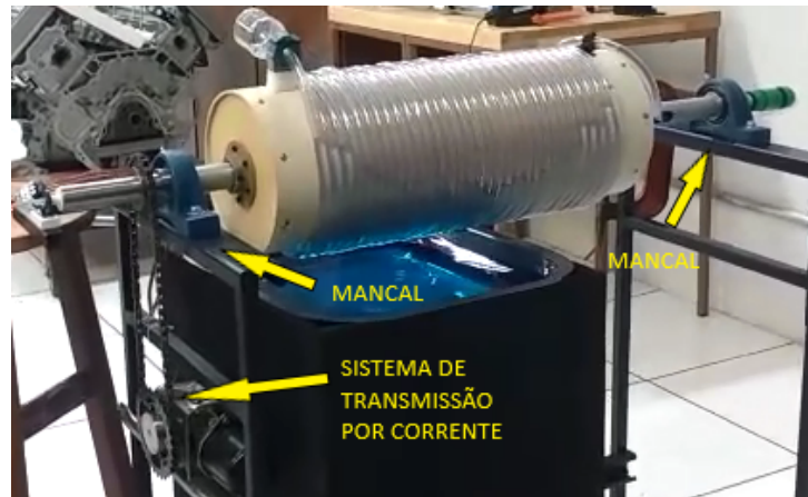
Figura 14 – Sistema de transmissão por corrente para movimento giratório do tambor
