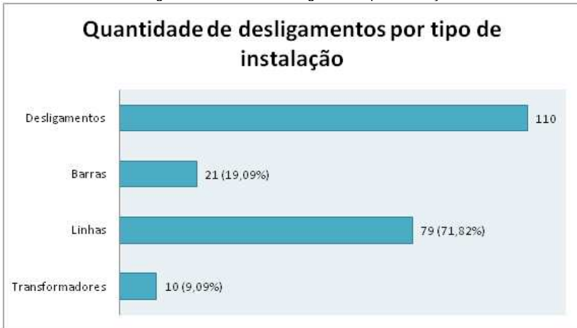
Figura 29 - Gráfico de desligamentos por instalação
