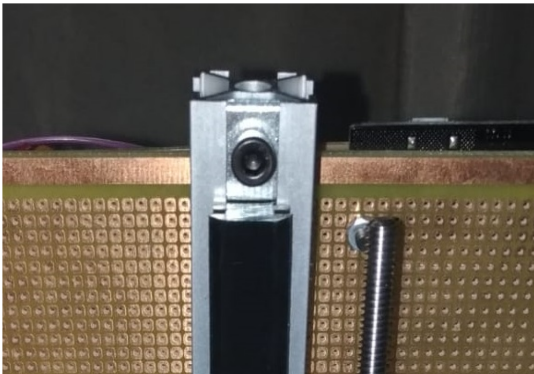
Figura 39 – Detalhe da porca quadrada fixa no perfilado do eixo Z.
