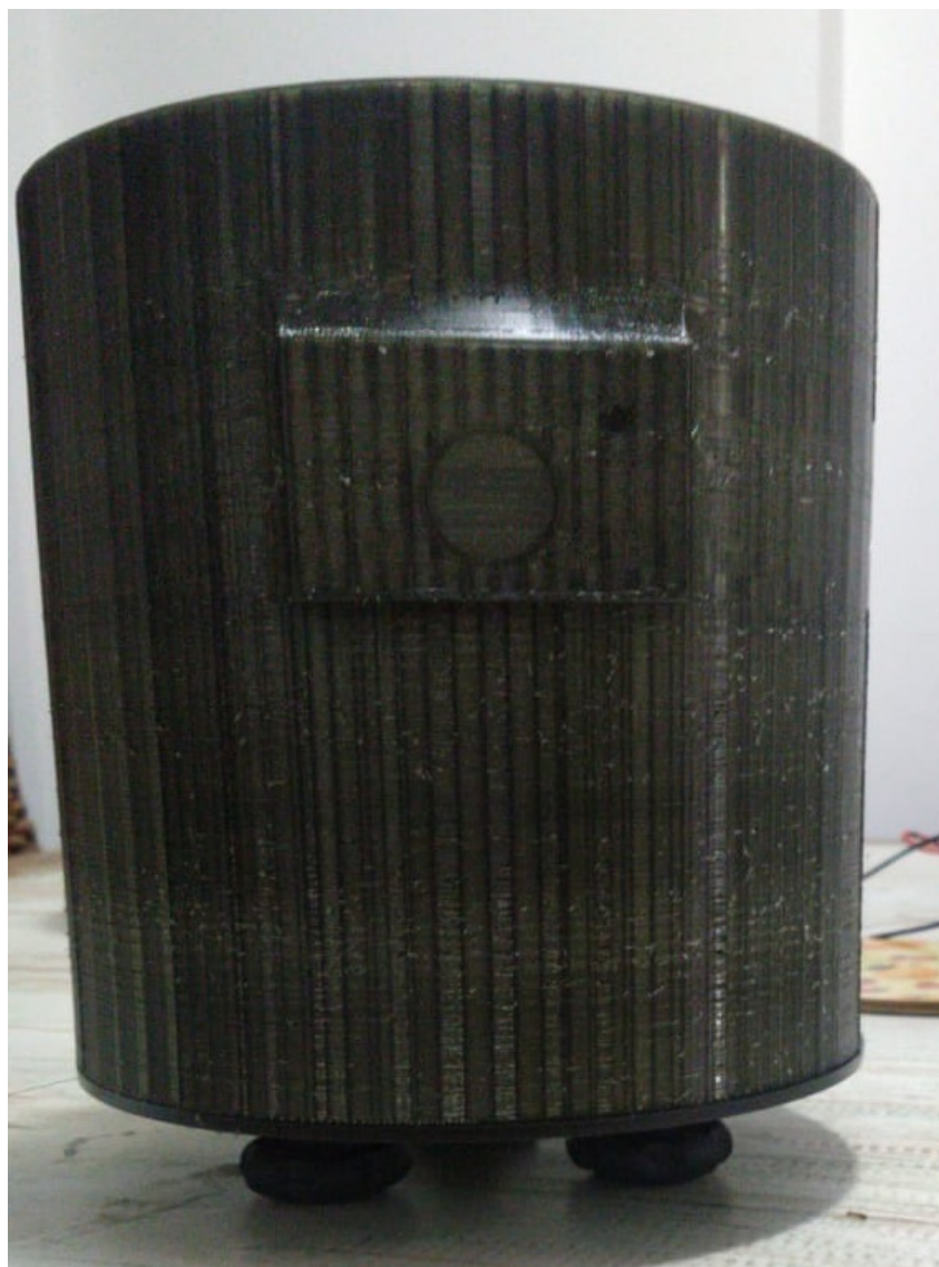
Figura 40 – Carcaça externa cilíndrica impressa em 3D, com detalhamento da face retangular ressaltada.
