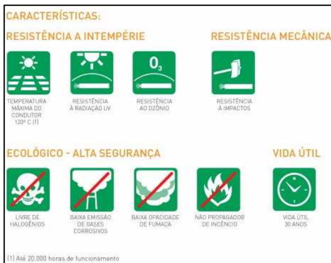
Figura 21 – Características do cabeamento solar.
