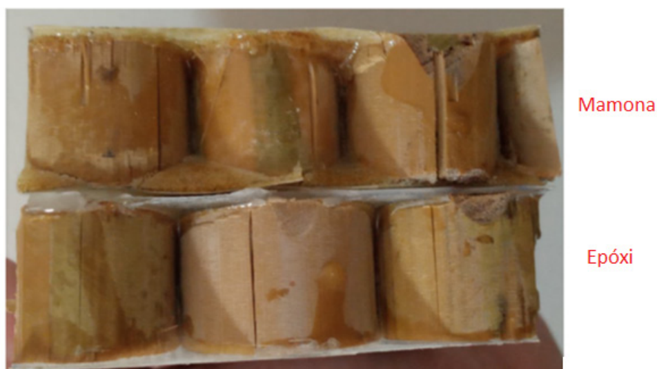
Figura 47 - Corpos de prova de compressão com núcleo rachado
