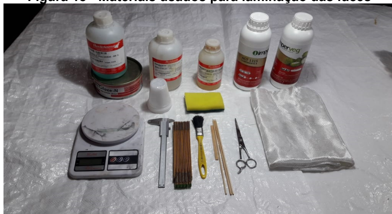
Figura 18 - Materiais usados para laminação das faces
