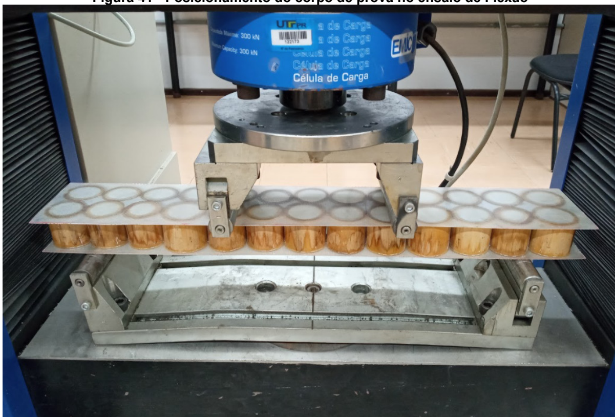
Figura 41 - Posicionamento do corpo de prova no ensaio de Flexão
