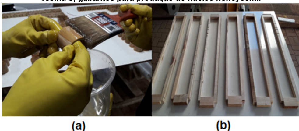
Figura 14 – Aplicação de resina no bambu para colagem do núcleo: a) aplicando camada de resina b) gabaritos para produção do núcleo honeycomb
