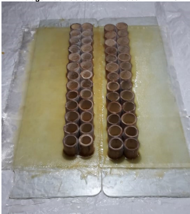
Figura 27 - Colagem do núcleo em uma face – FLEXÃO MAMONA
