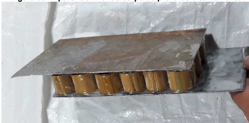
Figura 36 - Aparência final do corpo de prova de cisalhamento
