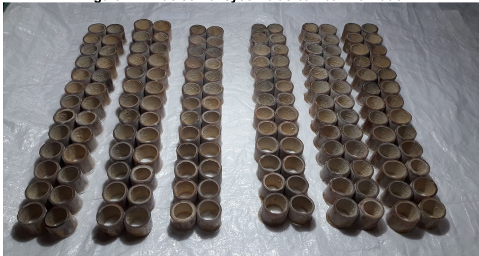
Figura 17 - Núcleo honeycomb de bambu finalizado
