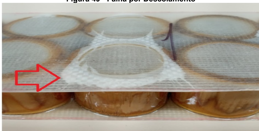
Figura 49 - Falha por Descolamento
