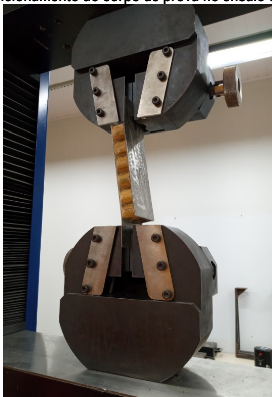
Figura 45 - Posicionamento do corpo de prova no ensaio de cisalhamento
