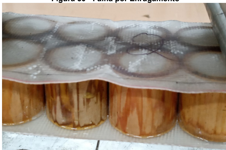
Figura 50 - Falha por Enrugamento
