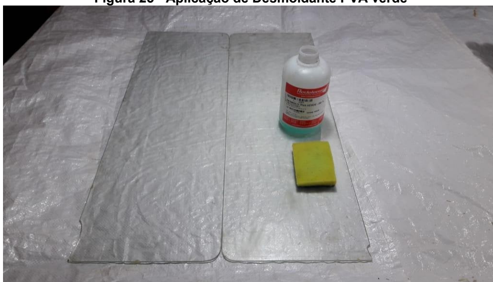
Figura 25 - Aplicação de Desmoldante PVA verde
