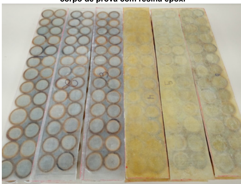
Figura 42 - Corpos de prova usados no ensaio de flexão: a) corpo de prova com resina epóxi b) corpo de prova com resina epóxi
