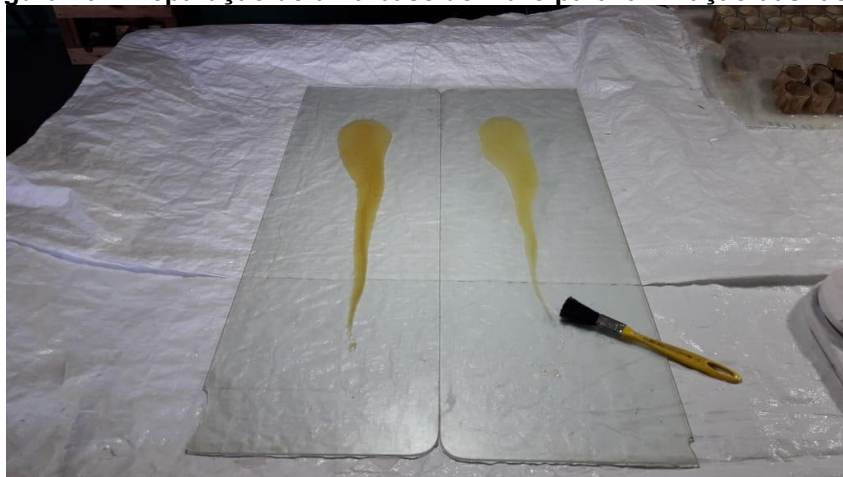
Figura 26 - Preparação de uma base de vidro para laminação das faces
