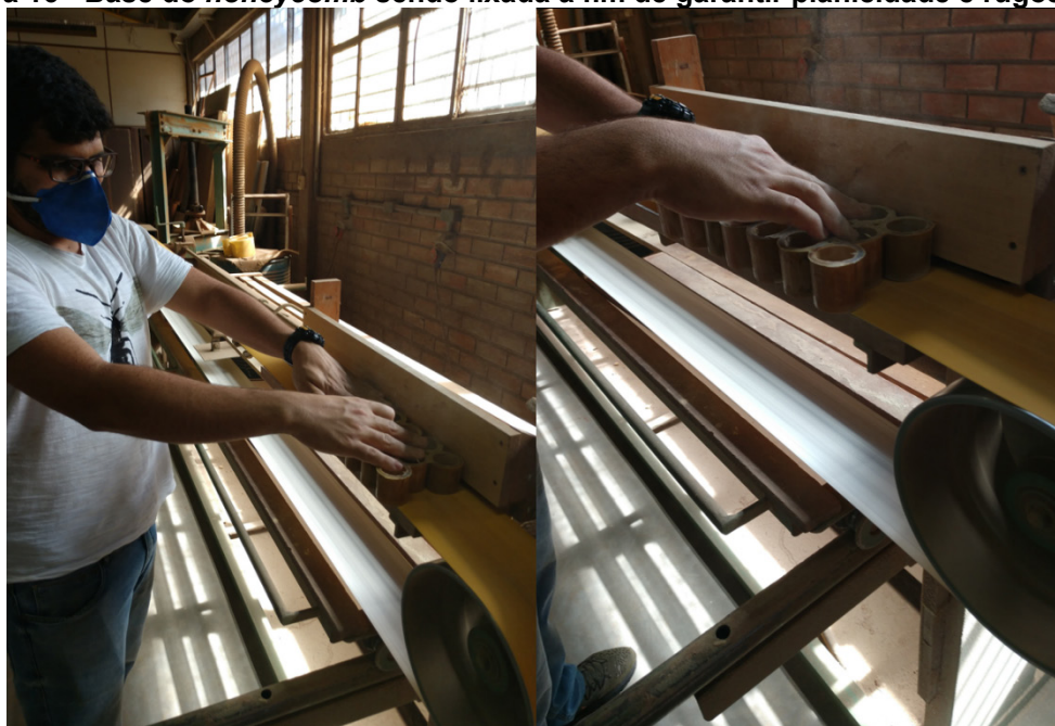
Figura 16 - Base do honeycomb sendo lixada a fim de garantir planicidade e rugosidade
