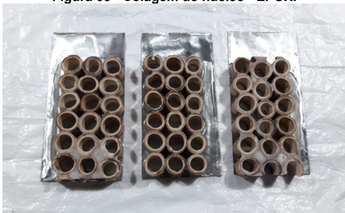
Figura 35 - Colagem do núcleo - EPÓXI
