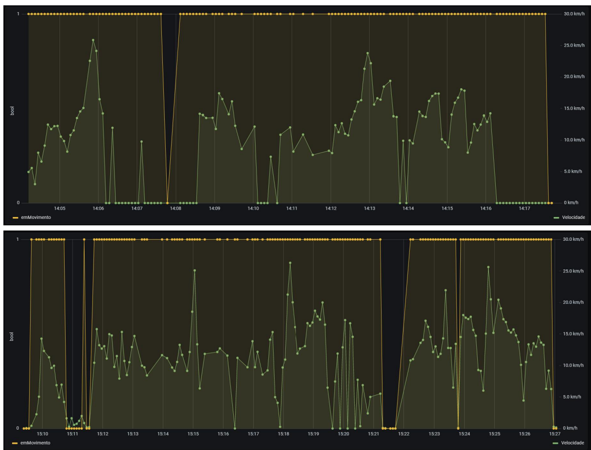
Figura 52 – Resultados de detecção de movimento do veículo no percurso da Sede ao Leme, acima, e do Leme à sede, abaixo.
