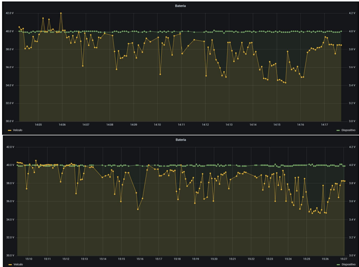
Figura 57 – Resultados de monitoramento da bateria do veículo no percurso da Sede ao Leme, acima, e do Leme à Sede, abaixo.
