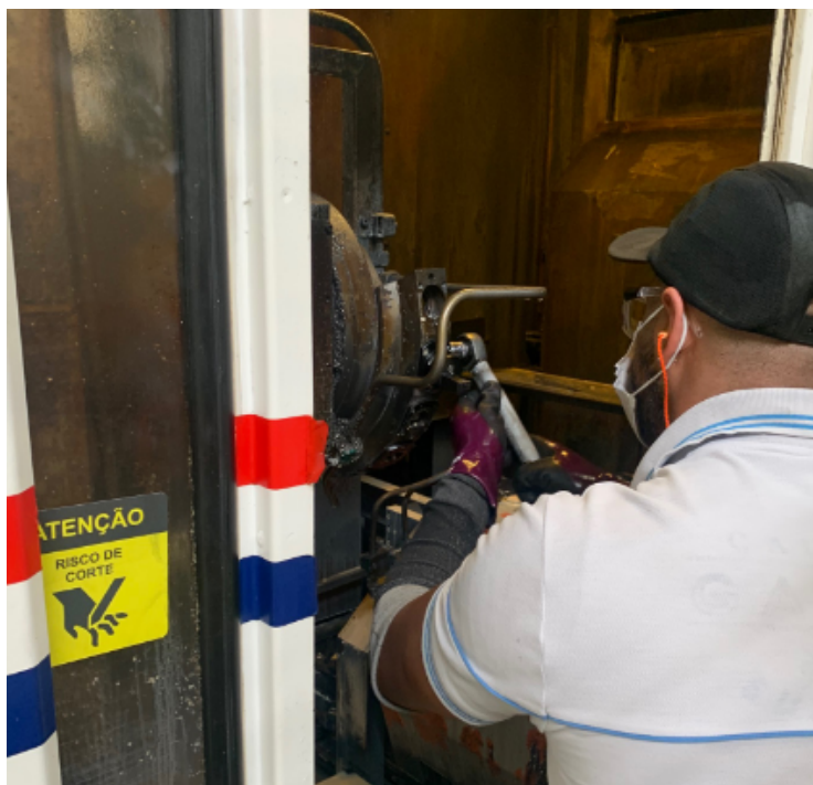
Figura 36 - Substituição da do corpo da ferramenta
