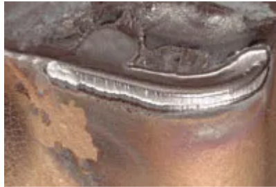
Figura 14 - Desgaste de flanco
