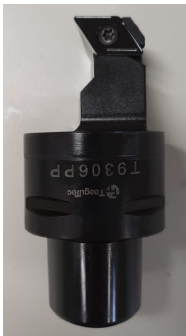
Figura 35 - Novo corpo de ferramenta Capto
