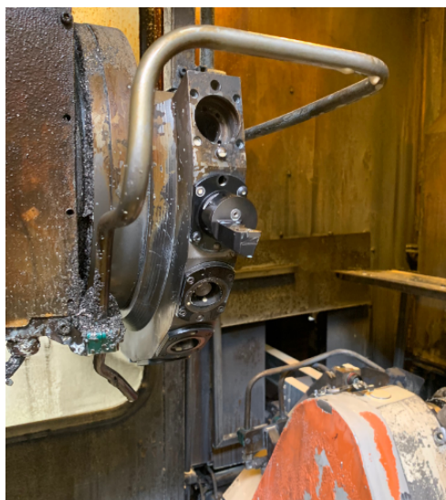
Figura 12 - Fixação das ferramentas na máquina
