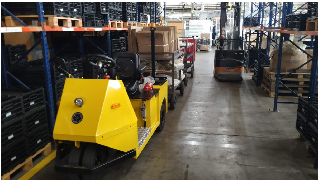
Figura 4.3 – Rebocador e comboio de logística interna ( Mizusumashi ).
