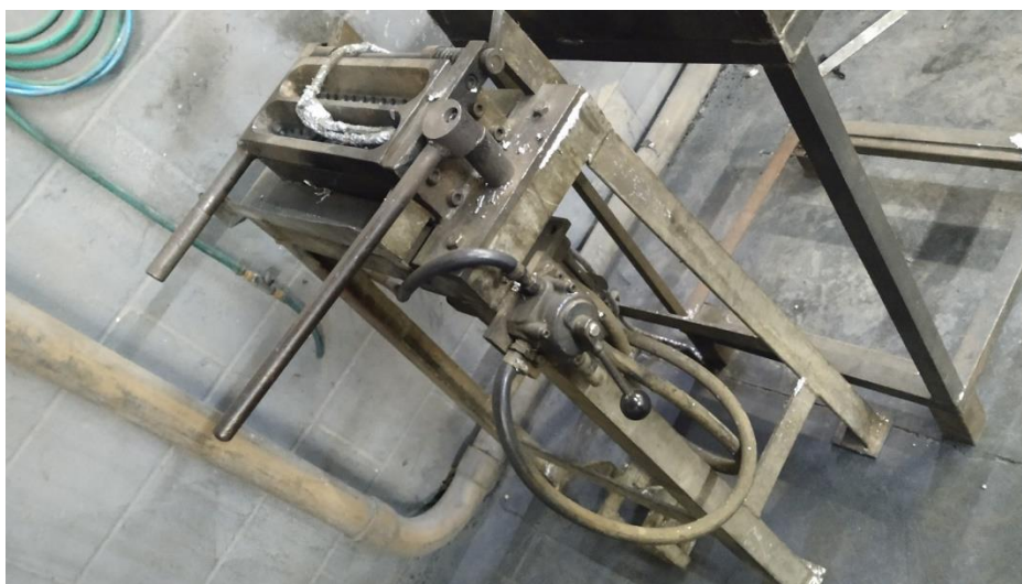
Figura 2.2 - Coquilha manual para insertos de chumbo.
