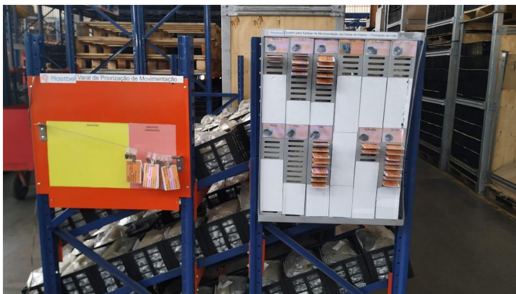
Figura 4.8 – Quadro formador de lotes para kanbans de movimentação.
