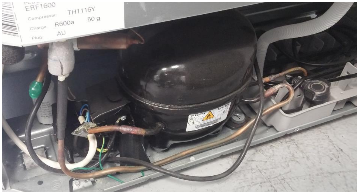
Figura 2.4: Fotografia de um produto comercializado no Brasil com calha de evaporação (elemento plástico de cor cinza à direita) fixada à base do compressor.
