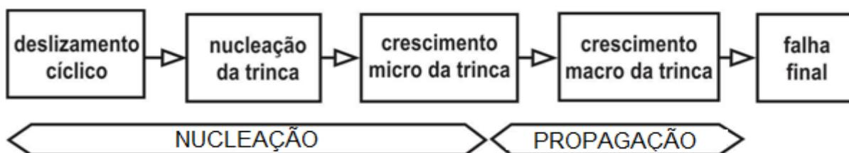
Figura 2.1 – Etapas do processo de evolução da trinca
