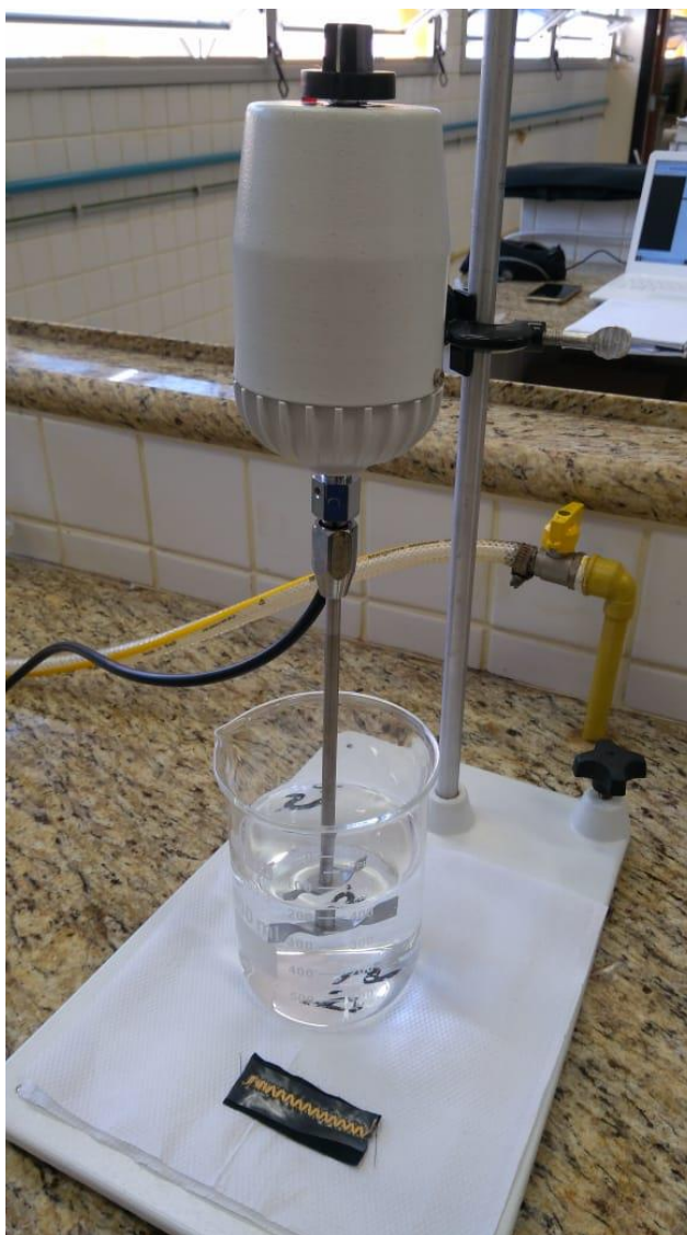
Figura 6 - Simulação do processo de lavagem da peça bordada com a entretela hidrossolúvel.
