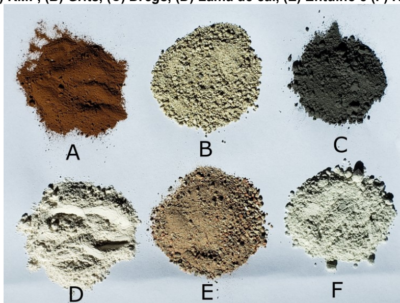
Figura 13 - Amostras utilizadas na pesquisa (A) RMF, (B) Grits , (C) Dregs , (D) Lama de cal, (E) Entulho e (F) RPC.
