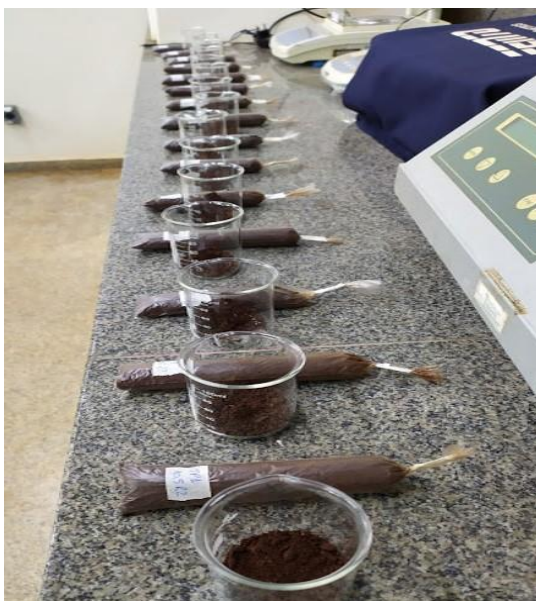
Figura 7 - Amostras de solos submetidas a análise de condutividade elétrica. UTFPR, Campus Pato Branco, 2022.
