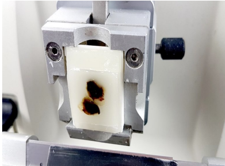
Fotografia 5– Representação fotográfica do posicionamento de um bloco de parafina no micró-tomo.
