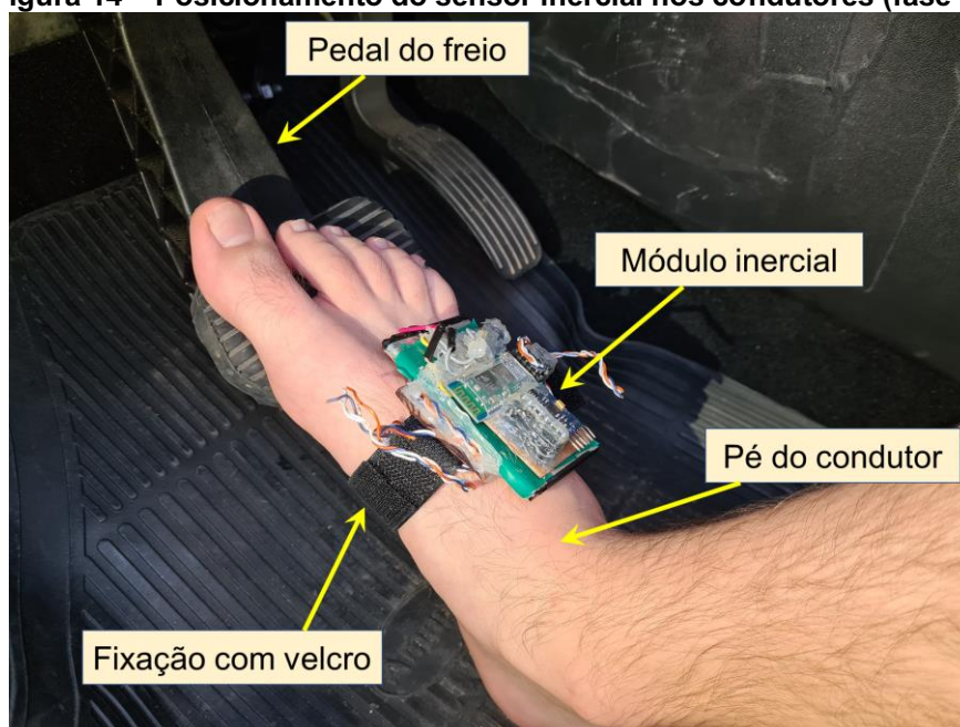
Figura 14 – Posicionamento do sensor inercial nos condutores (fase 1).
