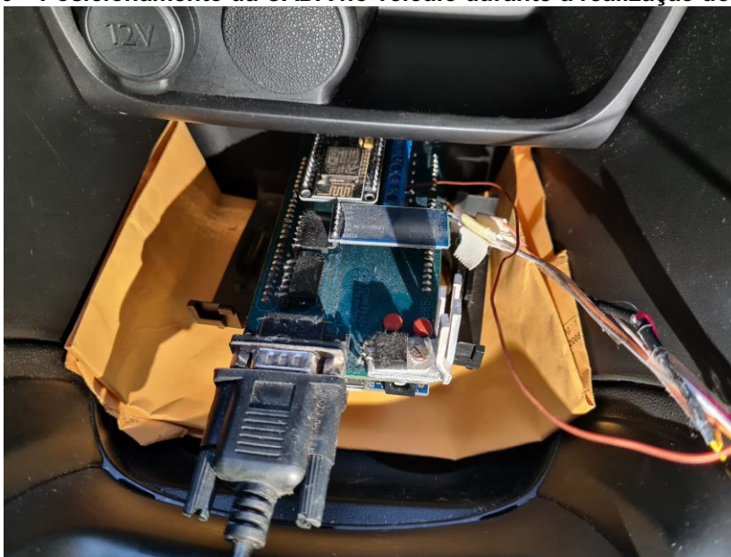
Figura 6 – Posicionamento da CADA no veículo durante a realização dos testes.
