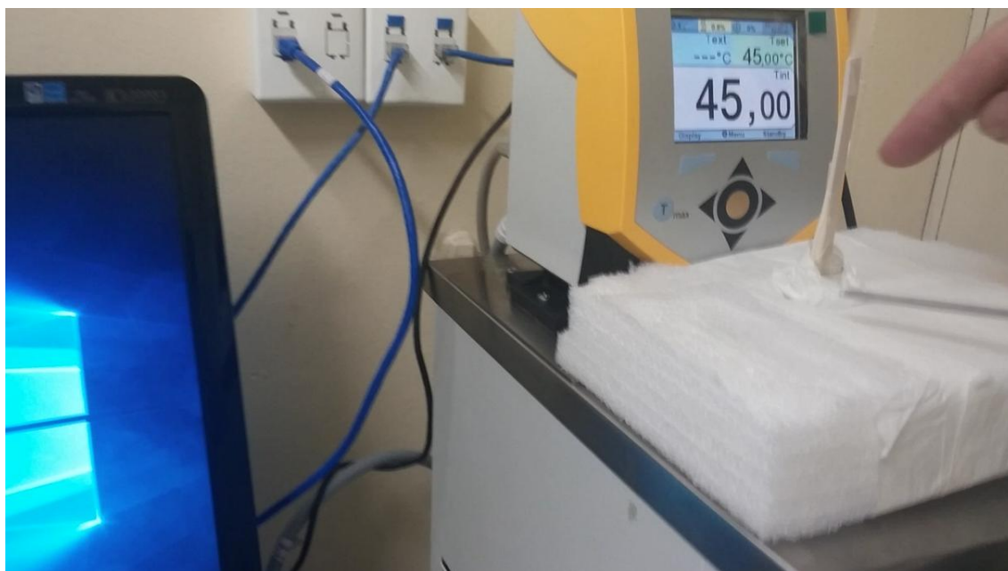
Figura 11 - Rede sensora em um tubo de ensaio mergulhado no banho térmico.
