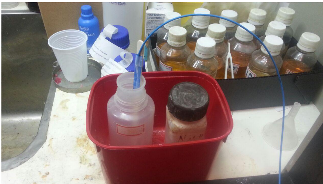
Figura 9 - Processo de corrosão da fibra em ácido fluorídrico.
