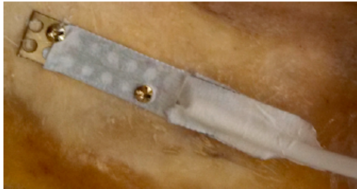
Figura 4.6: Sensor com o encapsulamento desenvolvido.
