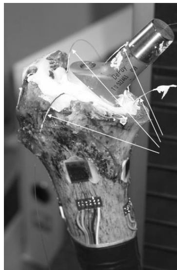
Figura 2.2: Configuração experimental com strain gauges e fibras óticas (indicadas por setas). Prótese de haste femoral cimentada no canal medular.
