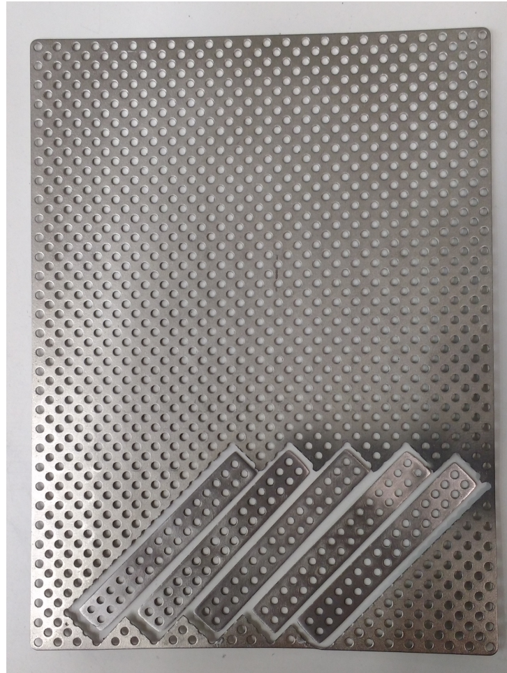
Figura 4.5: Malha de titânio inteira com as cinco amostras cortadas.
