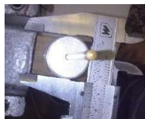
Figura 3: medindo o diâmetro
