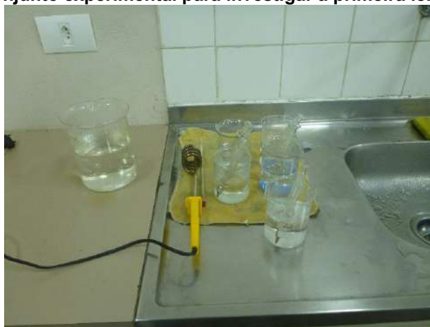
Fotografia 26 - Conjunto experimental para investigar a primeira lei da termodinâmica
