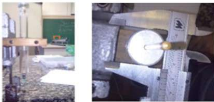
Fotografia 16 - Medição do diâmetro do êmbolo com paquímetro
