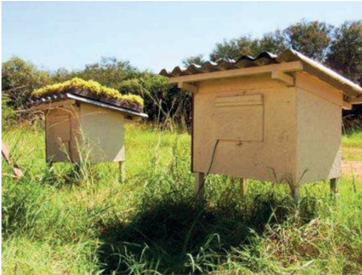
[F1 b] Experimentos para medição do desempenho do telhado verde. Fonte: Moraes (2013).
