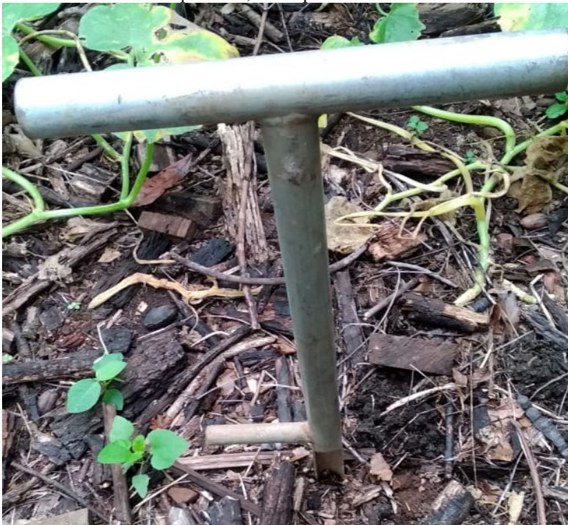
Foto 03 – Amostrador tipo sonda, usado para coleta das amostras de solo 1
