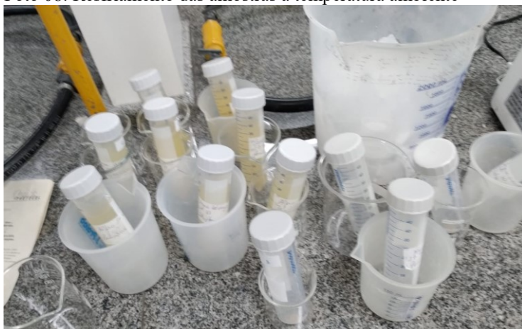
Foto 08: Resfriamento das amostras a temperatura ambiente
