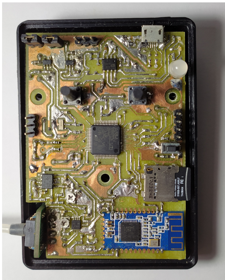
Figura 34: PCB no estado final com componentes montados
