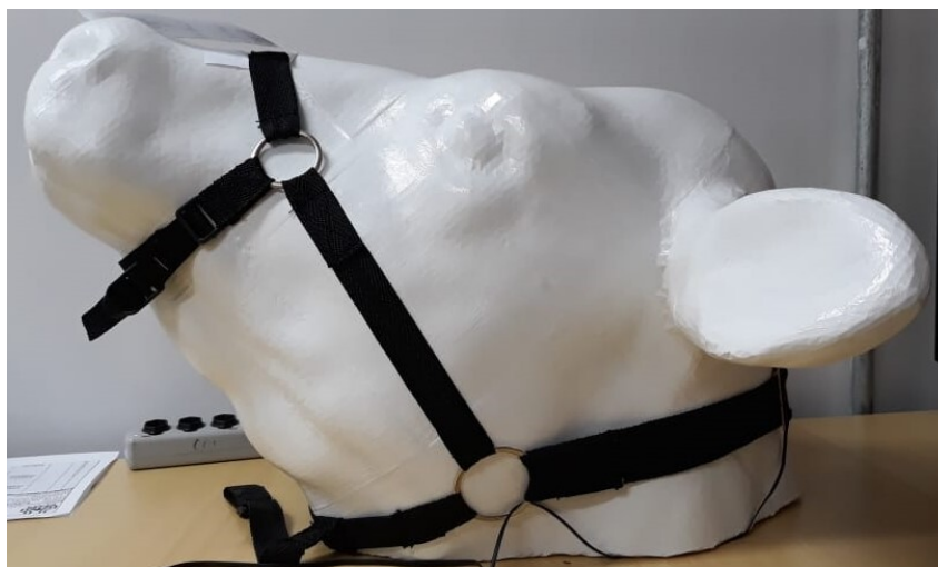
Figura 15: Buçal confeccionado de material elástico posicionado em réplica de tamanho real de cabeça de bovino
