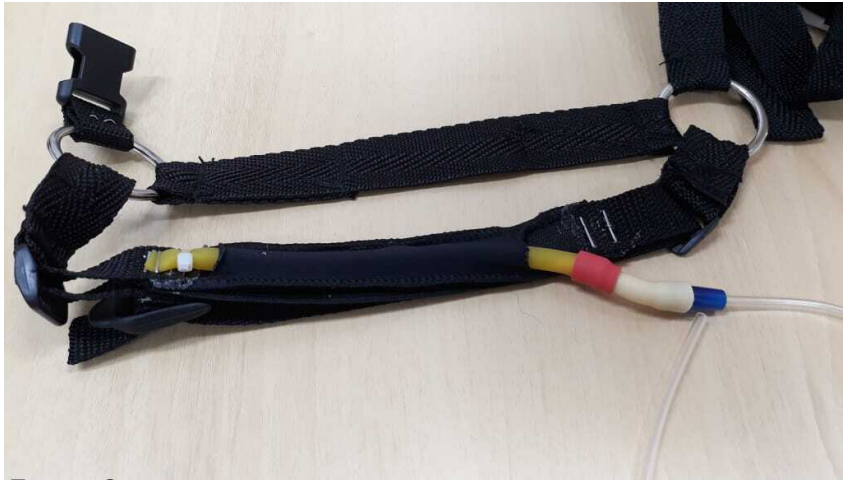
Figura 16: Tubo de borracha fixado na parte inferior do buçal adaptado
