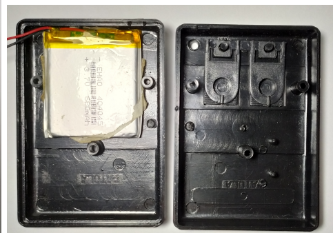
Figura 30: Invólucro plástico aberto com bateria do sistema encaixada
