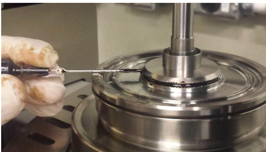
Figura A.1. Método de inserção de amostra no espaçamento entre as placas de medição do reômetro.
