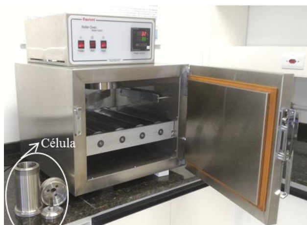
Figura 3.2. Estufa rotativa FANN 704ES e célula com tampa em rosca utilizada para formulação das amostras.
