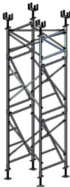
Figura 6 - Cimbramento Metálico Fonte: Doka, 2014.
