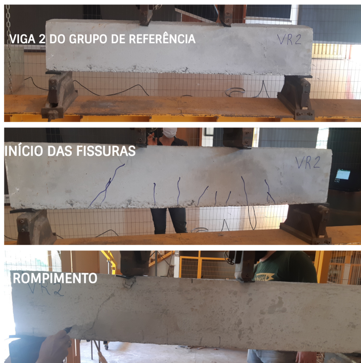
Figura 39 – Ensaio de Suttgart - VR-2 Fonte: Autoria Própria (2020).
