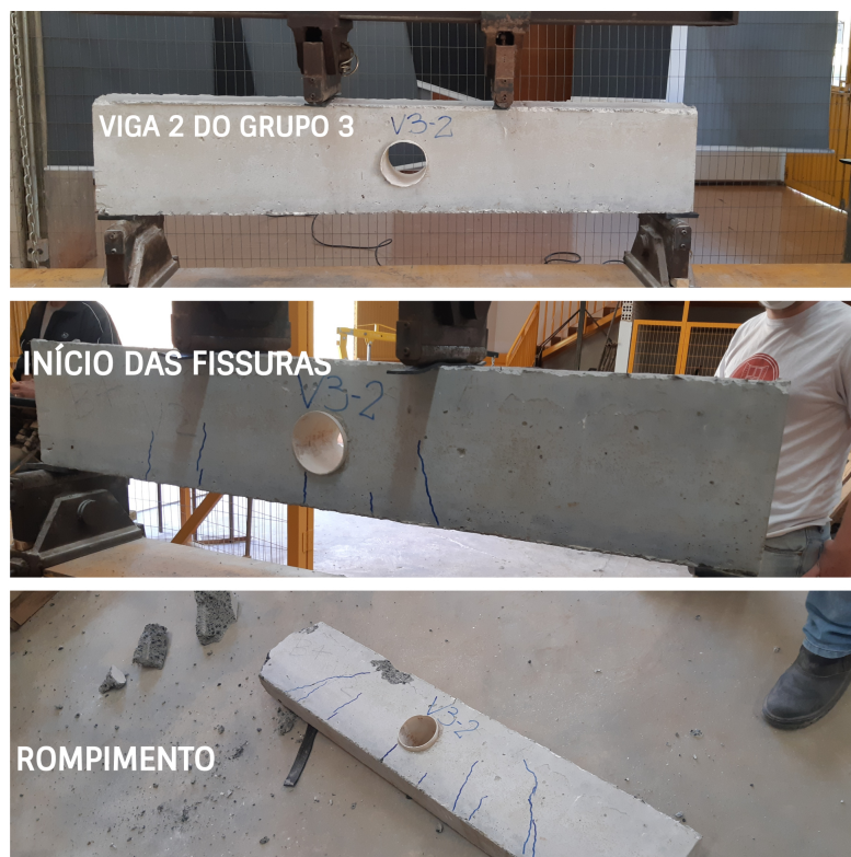
Figura 48 – Ensaio de Stuttgart - V3-2 Fonte: Autoria Própria (2020).
