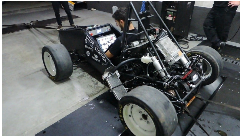
Figura 38 - Calibração do sistema de injeção e ignição do protótipo.
