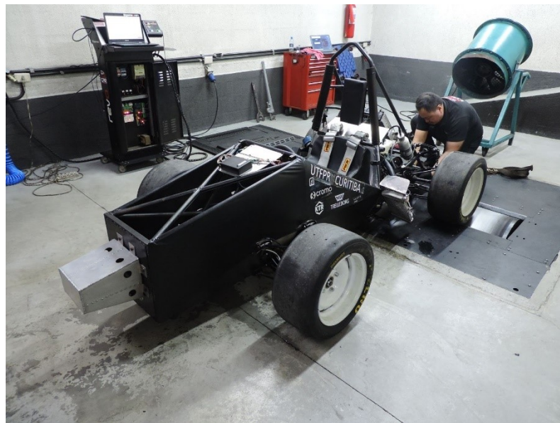
Figura 37 - Fixação do protótipo no dinamômetro.
