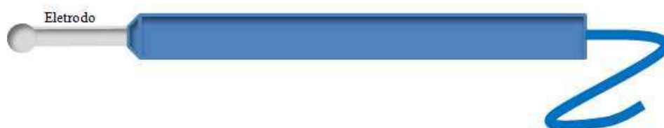
Figura 4 - Caneta sem comando e com eletrodo monopolar tipo bola. Fonte: Autoria própria
