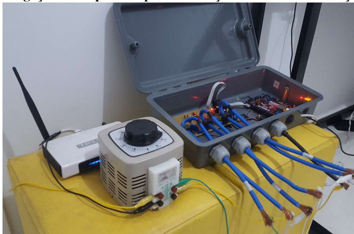
Figura 33: Ligação do dispositivo para realização dos testes de variação de tensão
