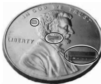
Figura 8: Sensores biotelemétricos passivos para monitoração da pressão arterial, produzidos pela empresa ISSYS. Comparação entre as dimensões de três sensores e uma moeda de um centavo de dólar.
