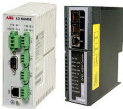
Fotografia 4 - Link Device - LD800HSE (ABB) e DF63 (SMAR) Fonte: Autoria própria
