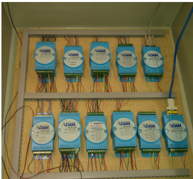
Fotografia 8 - Módulos de Entradas/Saídas Advantech Fonte: Autoria Própria
