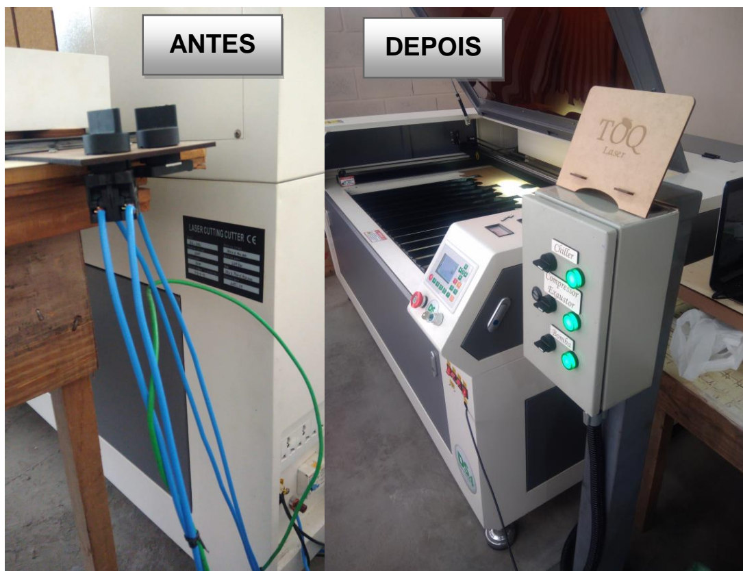
Figura 10. Comparação do painel de acionamento da máquina antes e depois do estudo. Fonte: Próprio autor.
