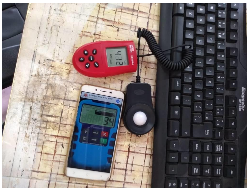
Figura 14. Medição de iluminação após nova instalação – mesa de desenho Fonte: Próprio autor.
