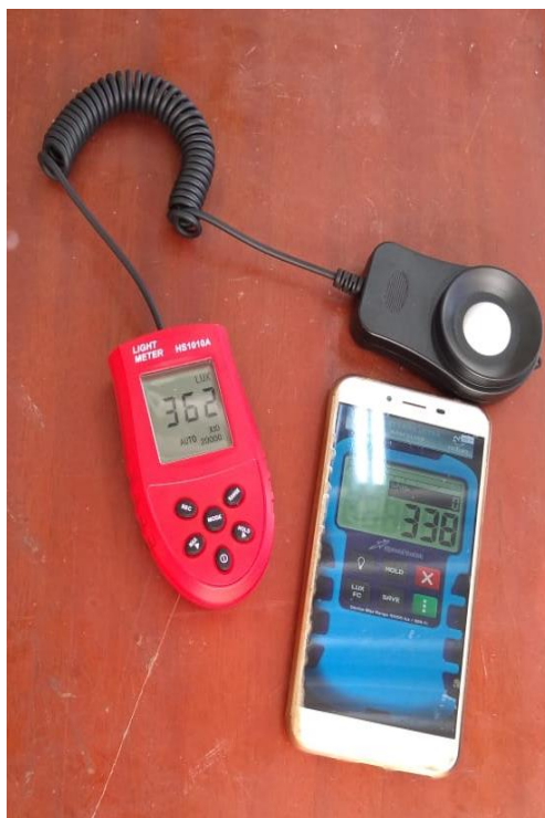
Figura 13. Medição de iluminação após nova instalação – mesa da montagem Fonte: Próprio autor.
