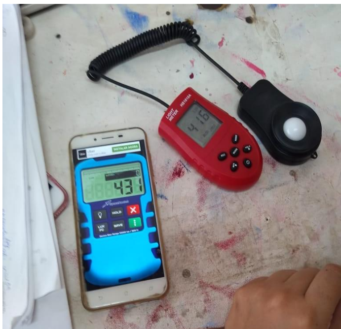
Figura 15. Medição de iluminamento após nova instalação – mesa de colagem Fonte: Próprio autor.
