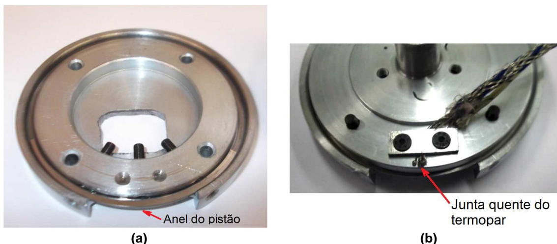
Figura 3.5 – Fotografia com detalhes do porta-anel: (a) Detalhes internos da tampa e do porta-anel (b) Fixação dos termopares na parte traseira.
