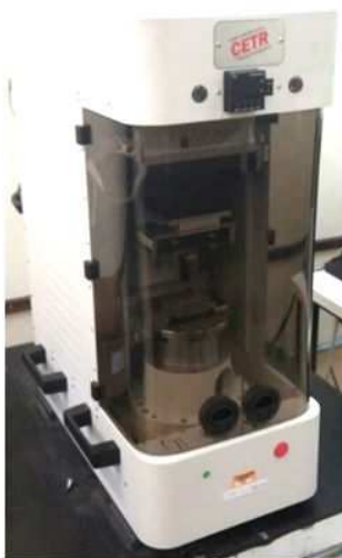
Figura 3.3 – Fotografia do aparato utilizado para os ensaios tribológicos.
