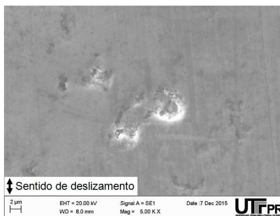
Figura 4.74 – Imagens obtidas por MEV mostrando detalhe de lascamento da superfície do anel do pistão em deslizamento contra o Ver-PG após 8 horas de ensaio (condição de F_N=75 N, f=5 Hz e C_p=10 mm).
