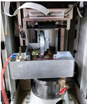
Figura 1 - Fotografia do aparato utilizado para os ensaios tribológicos.
