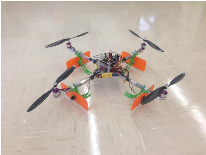
Figura 4 - Quadricóptero em desenvolvimento. Um sistema anti-colisão foi instalado através de sensores sonar
