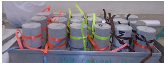
Figura 24 - corpos de prova pesados e identificados para a imersão. Fonte: A autoria própria (2016)
