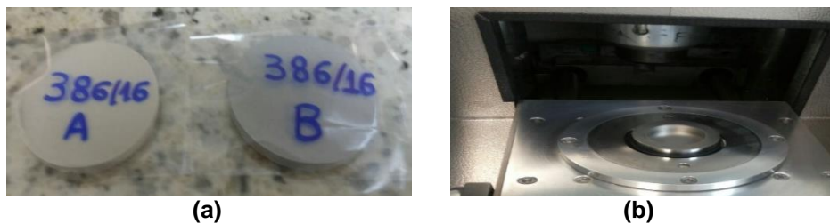
Figura 12 - Análise do EFRX, a) pastilhas prontas, (b) aparelho de prensagem das pastilhas. Fonte: Autoria própria (2016).
