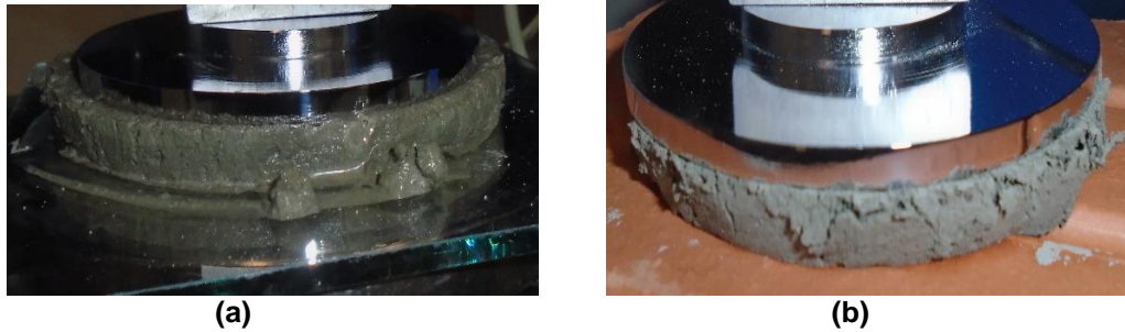
(a) (b) Figura 19 - Traço T-V sendo ensaiado em (a)placa de vidro e (b) bloco cerâmico. Fonte: Autoria própria (2016)
