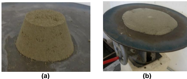
Figura 13 - Ensaio de T-I (a) cone moldado, (b) cone já feito o abatimento
