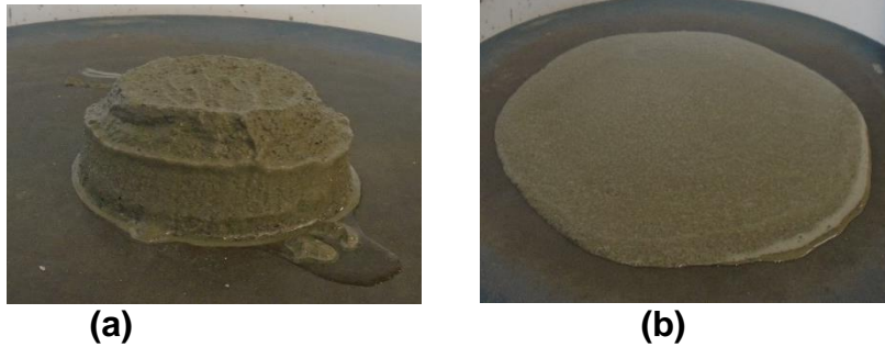
(a) (b) Figura 14 - Ensaio de ABRC, (a) cone moldado, (b) cone já feito o abatimento. Fonte: A autoria própria (2016)
