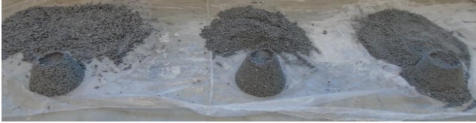
Figura 11 - Ensaio de absorção de água da areia de britagem de rocha calcária. Fonte: Autoria própria (2016)
