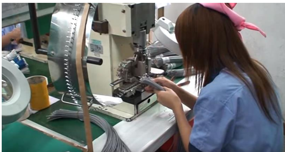
Figura 2.4 – Crimpagem de terminais
