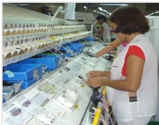
Figura 2.6 – Processo de pré-montagem Fonte: Manual de treinamento Yazaki do Brasil, 20/01/2008.
