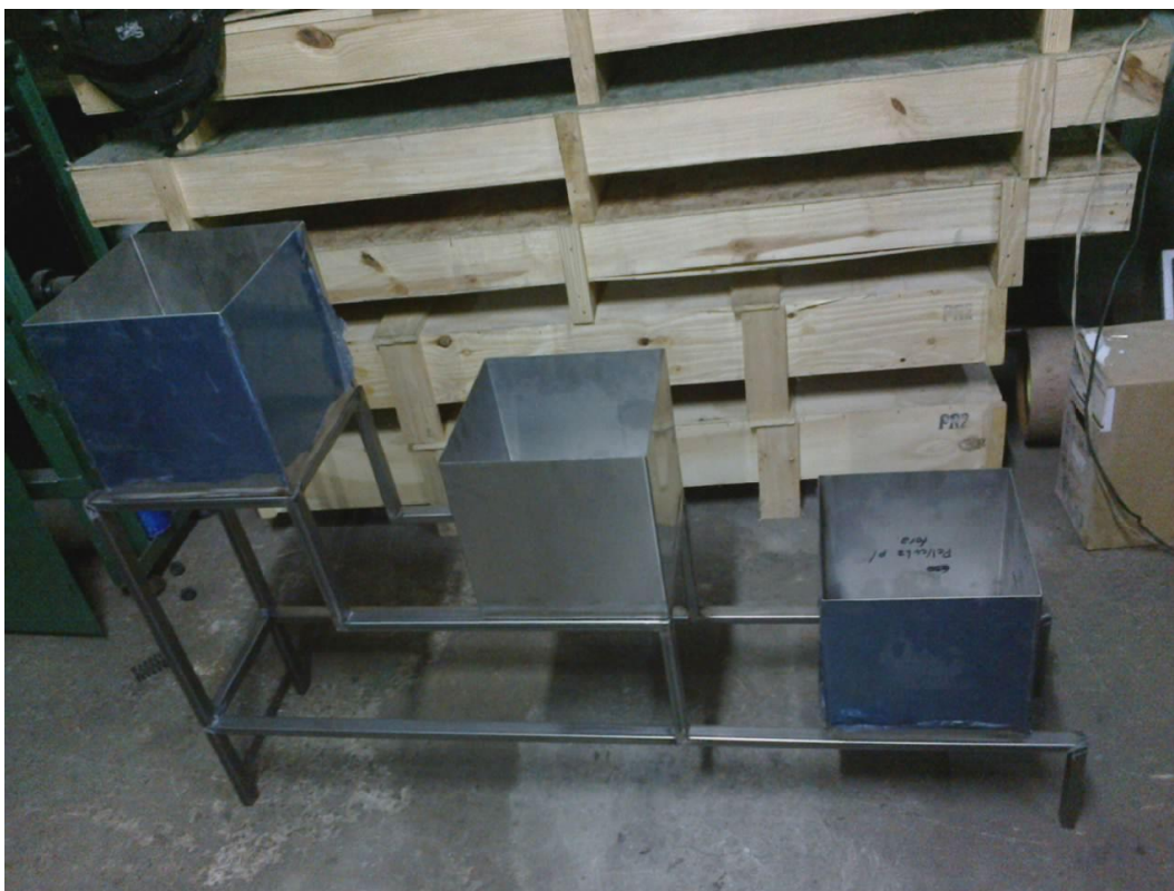
Figura 39 – Bancada com os tanques em desnível
