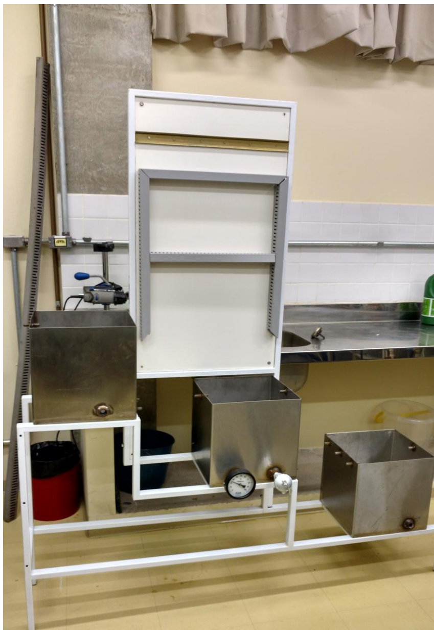
Figura 40 – Bancada com tanque em desnível e com o painel para instrumentação
