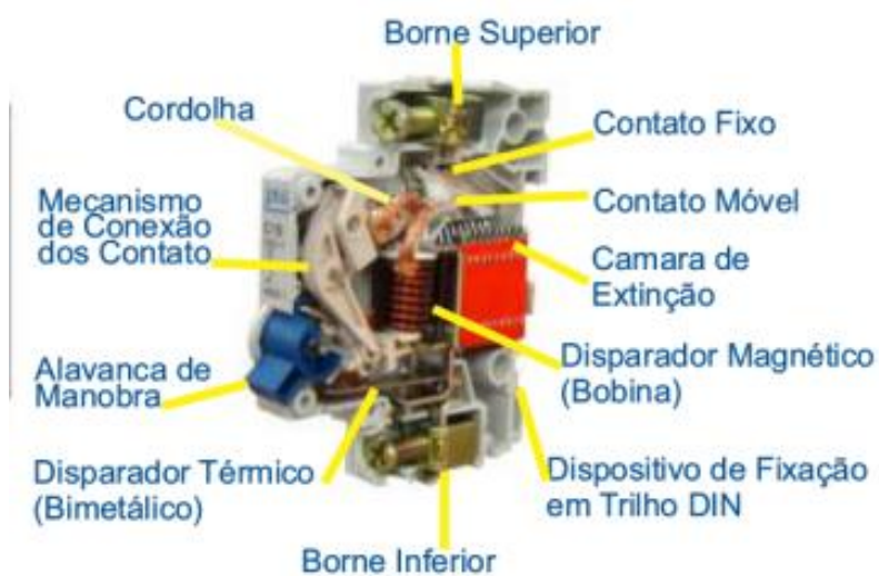
Figura 24 – Construção Interna Mini Disjuntor Termomagnético Fonte: Catálogo JNG, 2014
