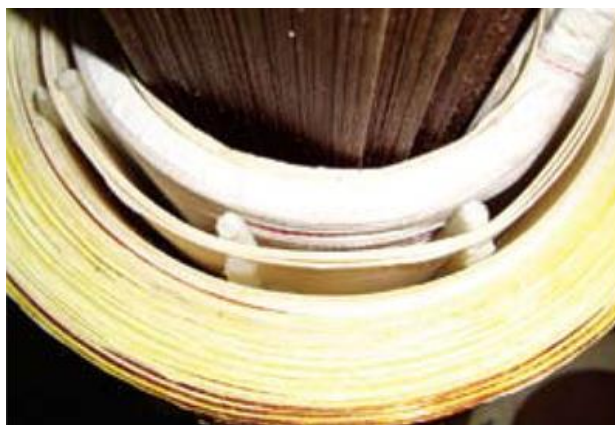
Figura 7: Canal de óleo da bobina Fonte: Comtrafo Transformadores S/A.
