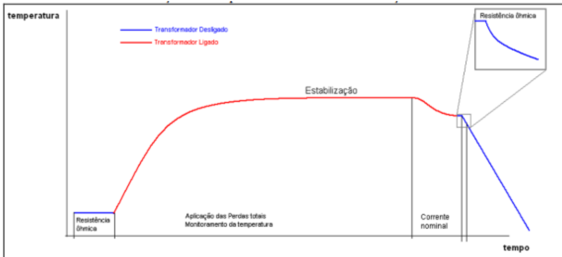
Figura 12: Gráfico do comportamento do ensaio de elevação de temperatura
