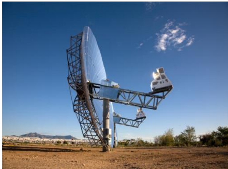
Figura 21: Foto de um concentrador de disco parabólico Fonte: GLOBAL NEVADACORP (2011)
