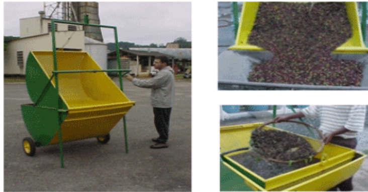
Figura 15- Separador Hidráulico (lavador) para café Fonte: www.cafepoint.com.br
