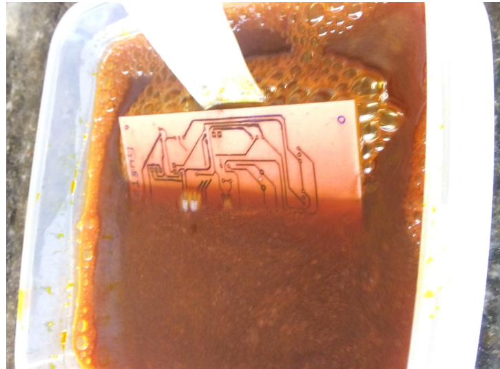
(a) Início da corrosão (cobre avermelhado).
