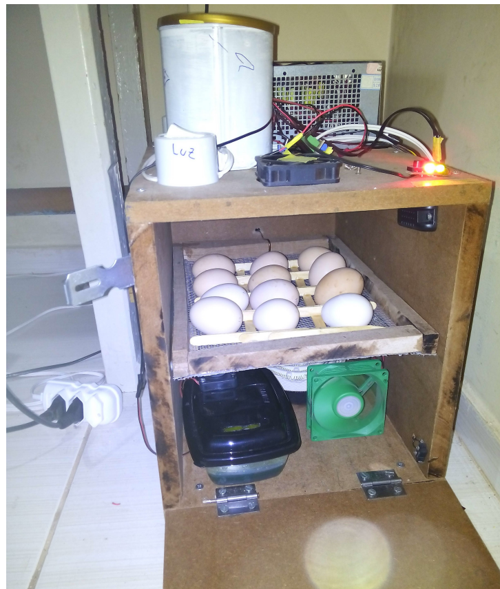
Figura 7 – Incubadora de ovos finalizada.
