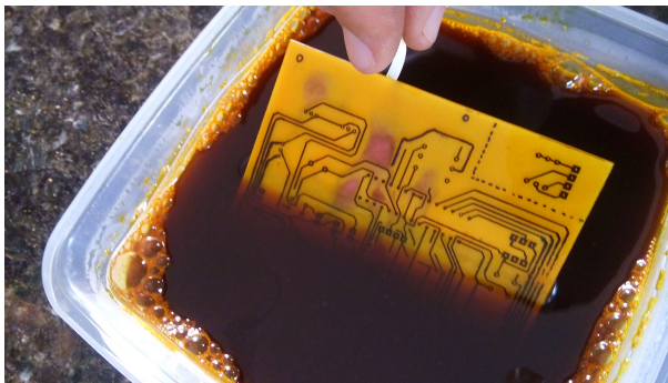
(b) Terminando a corrosão (cor do fenolite por quase toda a placa).
