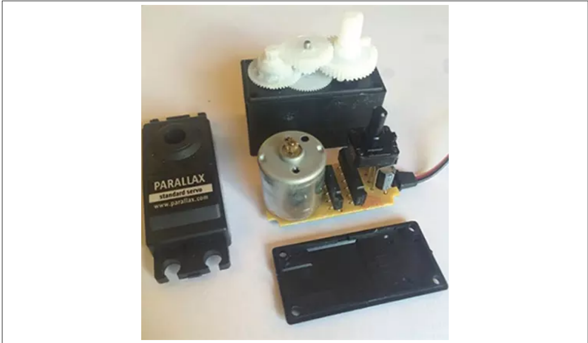
Figura 19 – Composição interna de um servomotor
