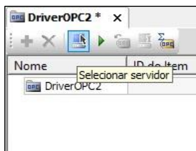
Figura 82 - Comunicação OPC Server (Eclipse SCADA) e OPC Client (Eclipse E3) – Selecionando servidor
