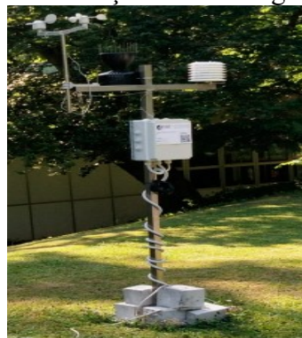
Figura 8 - Experimento de estação meteorológica baseada em Arduino
