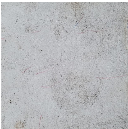
Figuras 46 e 47: Retração após o ensaio de ciclos nas argamassas referência
