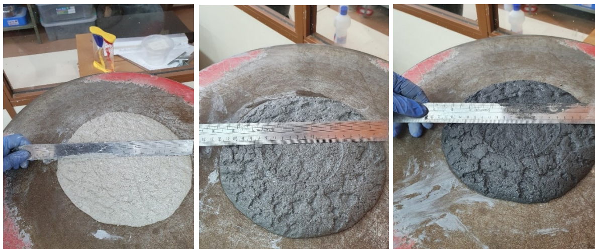
Figura 25: Índice de consistência das amostras (a) Ref; (b) CCA R ; (c) CCA M
