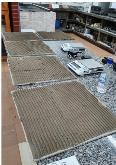
Figura 23: Placas com cordões de argamassa
