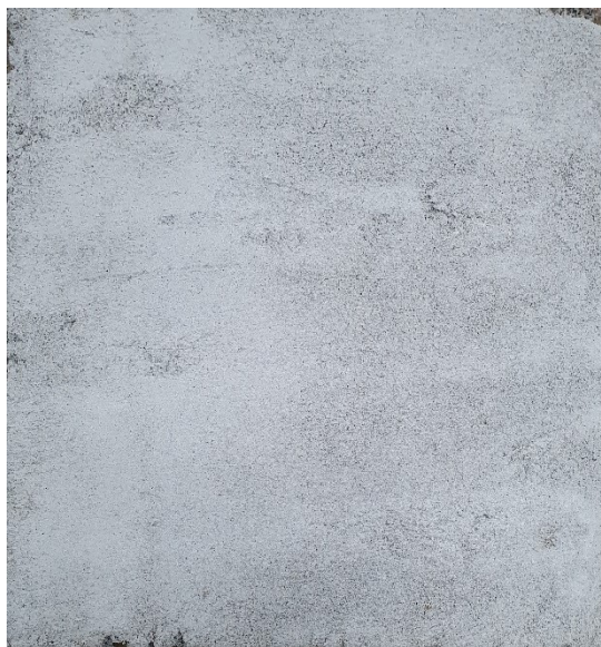
Figuras 48, 49 e 50: Retração após o ensaio de ciclos nas argamassas com cinza residual
