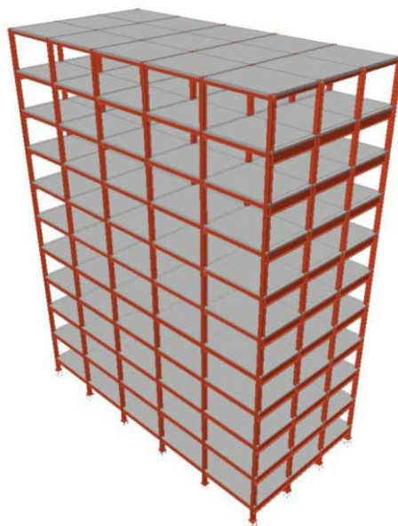
Figura 25 – Modelagem do edifício de 10 pavimentos (estrutura metálica)
