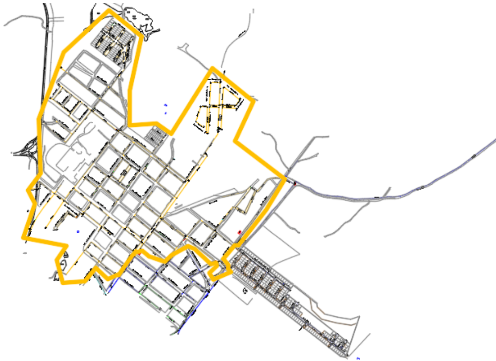
Figura 28 – Área abastecida pelo booster
